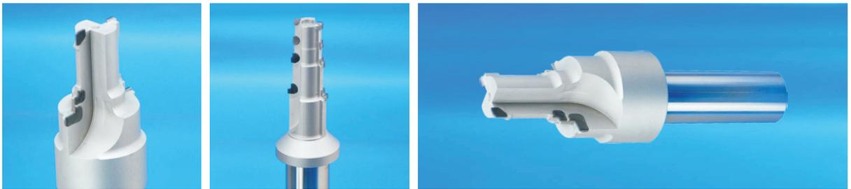
通常讲，PCBN加工应该干切削。‘PCBN材料硬到足够抵抗加工产生热量引起的变形，但它也脆到冷却液的热冲击就产生裂纹，’Huddle说。‘尤其是在断续切削的场合。有断续切削的PCBN加工决不能使用冷却液。’
